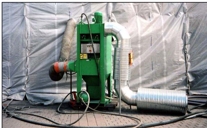
Mobil stofrensning av luftutsläpp från utombusblästring.
