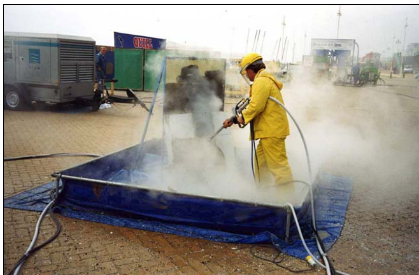
Demonstration av borttagning av färg med ultrahögtryck.
